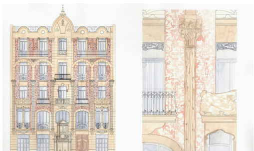
Fig. 2. Fachada y detalle del edificio Punt de Gantxo recayente a la plaza de la Almoína pertenecientes al informe cromático del edificio
