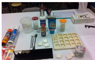
Fig.5. Testado de masillas de relleno para ser empleadas en obras escultóricas metálicas al aire libre.
